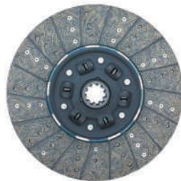
品名: CA380从动盘总成 规格: 380*200*10*44.55 适配车型: 柳特 巨能王 锡柴 九吨双桥 Product Name:CA380 driven disc assembly Specification:380*200*10*44.55 Fit models:LiuTe huge king Xichai nine tons double bridge
